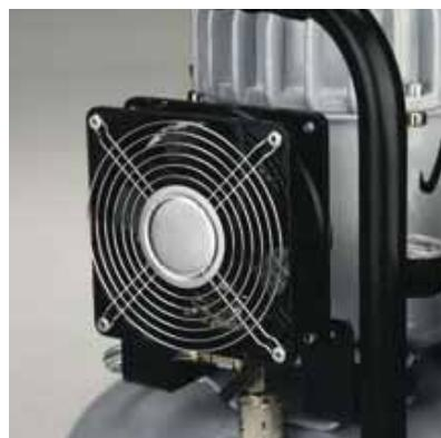
Вентилятор, установленный на компрессоре
