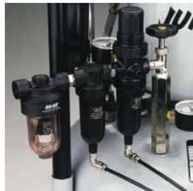
Фильтры, установленные на компрессоре
