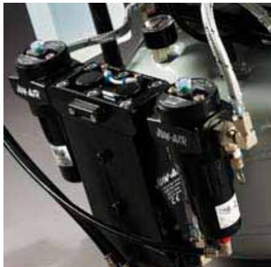
Адсорбционный осушитель D2, установленный на компрессоре
