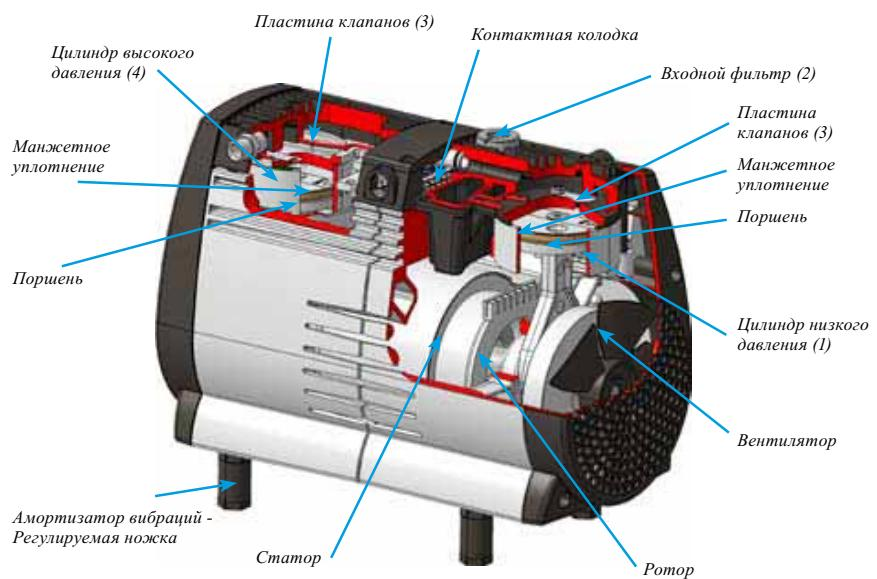
давления 3 бара (43 фунтов на кв. дюйм). В течение сжатия в цилиндре низкого давления поршень в цилиндре высокого давления (4) перемещается вниз и засасывает сжатый воздух из цилиндра низкого давления через соединительную трубку в цилиндре высокого давления. При
